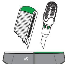
左可发言图标将亮起。右 **LED** 指示条和话筒 **LED** 指示灯将呈红色亮起：
