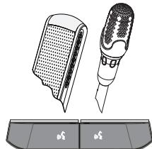
左侧的可发言图标将亮起。右侧的 **LED** 指示条和话筒 **LED** 指示灯呈绿色亮起或呈绿色闪烁：
